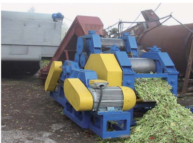
Utilajul ITA „Mecagro” pentru extragerea sucului din sorg zaharat
